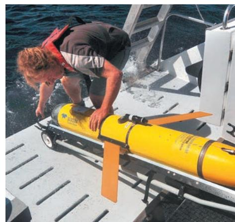
Ci-dessous : déploiement d'un planeur portable sous-marin, ordinairement appelé « planeur Slocum », qui utilise une batterie embarquée pour les communications, les capteurs et les ordinateurs de navigation.
