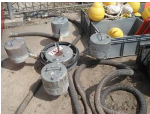
La tête d'écumage permettant la collecte des hydrocarbures de la surface de l'eau.
