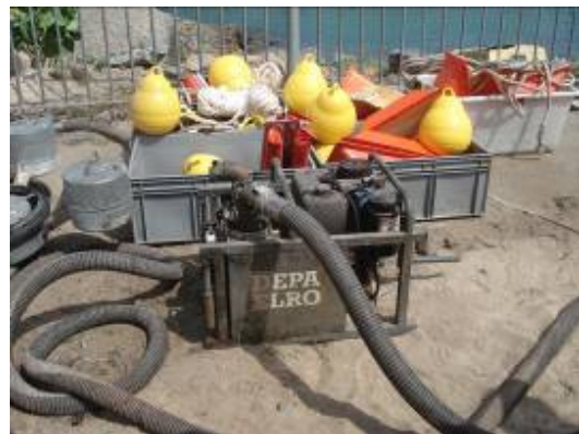
La pompe associée à la tête d'écumage et les accessoires pour les barrages.
