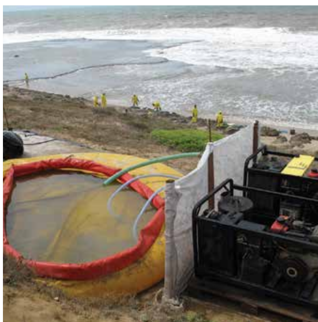
▲ Figure 22 : Lavage haute pression de rochers dans un lieu isolé. De l'eau de mer est pompée dans le réservoir de stockage temporaire pour être utilisée par les nettoyeurs haute pression placés à côté.
