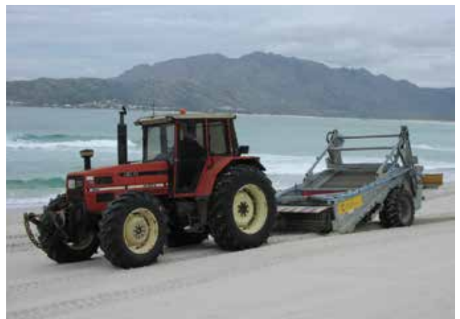
▲ Figure 26 : Cribleuse tractée récupérant des boulettes d'hydrocarbure sur une plage.
