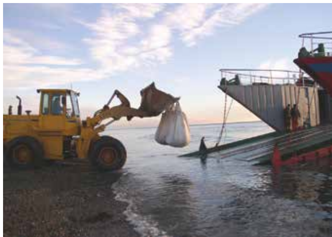
▲ Figure 11 : Des petits sacs de déchets regroupés dans des « big-bags » d'une tonne sont transportés sur une péniche de débarquement pour les évacuer d'un littoral isolé.
