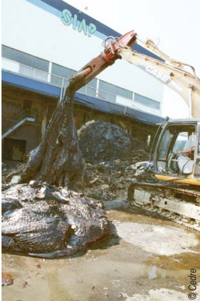
Unité de traitement des déchets industriels spéciaux : arrivée de MPP sur site et résultat du traitement.
