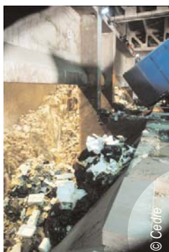
Usine d'Incinération d'Ordures Ménagères : déchargement des MPP et traitement préalable à l'incinération.
