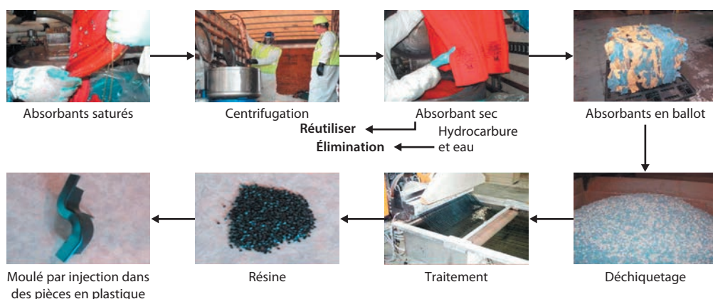
Figure 7 Présentation du processus de recyclage des barrages plastiques
