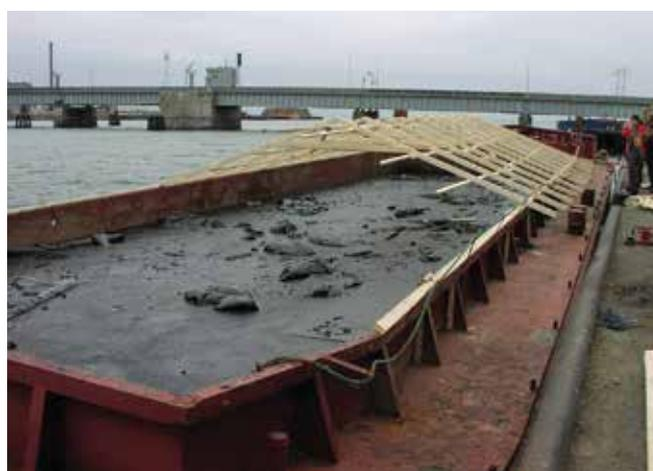
▲ Figure 10 : Hydrocarbures récupérés stockés dans une barge. Une couverture est nécessaire pour empêcher la pénétration de l'eau de pluie.
