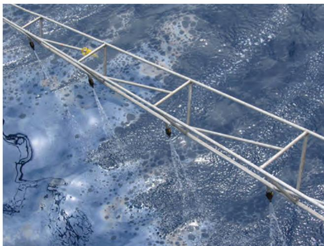
▲ Figure 7 : Application de dispersant sur une irisation au moyen de rampes d'épandage montées sur navire, entraînant la « répulsion » de l'hydrocarbure au lieu de sa dispersion.
