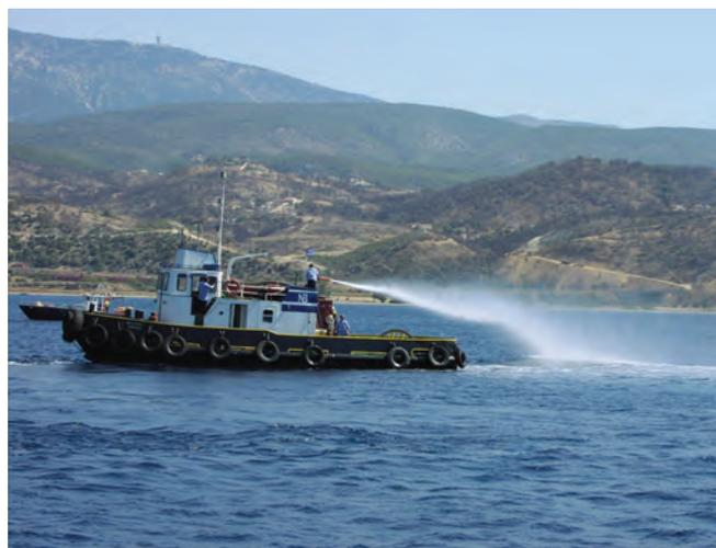
▲ Figure 8 : Application de dispersant au moyen de canons incendie à bord d'un remorqueur, montrant une répartition inégale du dispersant et l'effet du vent.
