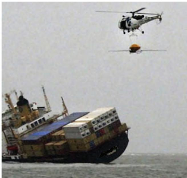
▲ Figure 11 : Système d'épandage hélicoptéré approchant un déversement de fioul récent. Pour être efficace, une application à plus basse altitude serait nécessaire. (Image reproduite avec l'autorisation de la garde-côtière indienne).
