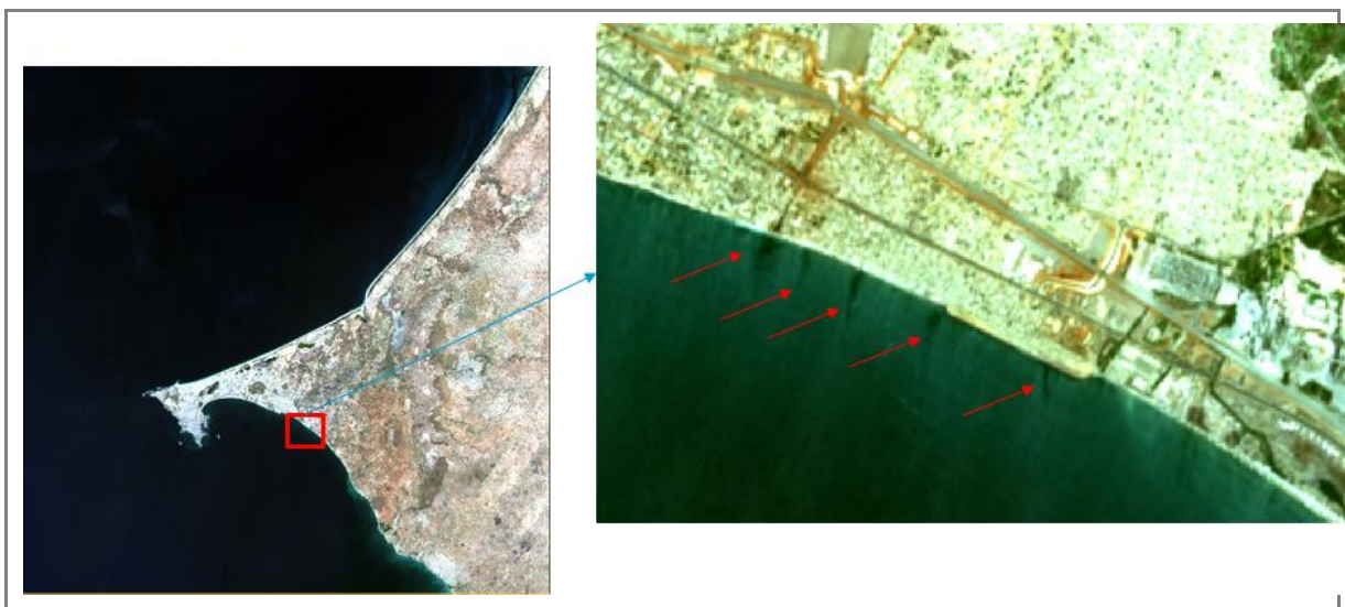
Figure 39 : Composite couleur d'une image Sentinel-2 MSI prise le 24 avril 2020. Bleu : bande 2, vert : bande 3 et Rouge : bande 4
